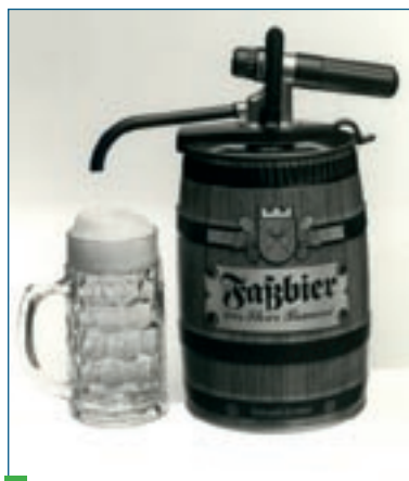
Die Fassform als Herausforderung: 1972 expandierten die Huber Spezialisten einen zylindrischen, an der Längsnaht geschweißten Dosenkörper von innen zur Fassform auf und fanden die richtige Innenlackierung.
